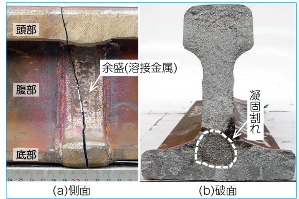
図3 凝固割れで折損したテルミット溶接部
