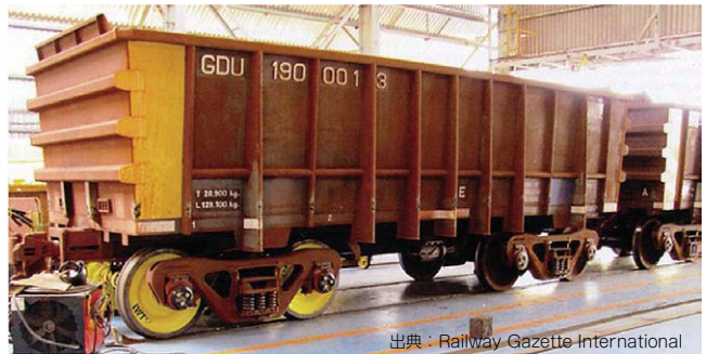
重量鉱石用貨車にIWT 4形試験輪軸が2本取り付けられ、レール・車輪関係のさまざまなデータを測定する。
