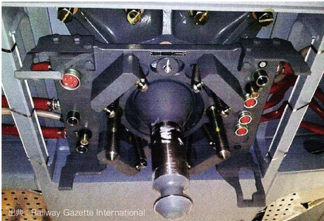
試験車両に取り付けられた電磁吸着レールブレーキ
