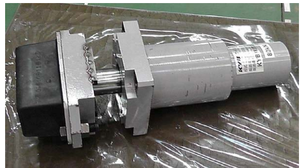
図7 クラッシュブルストッパー装置(油圧動作型)
