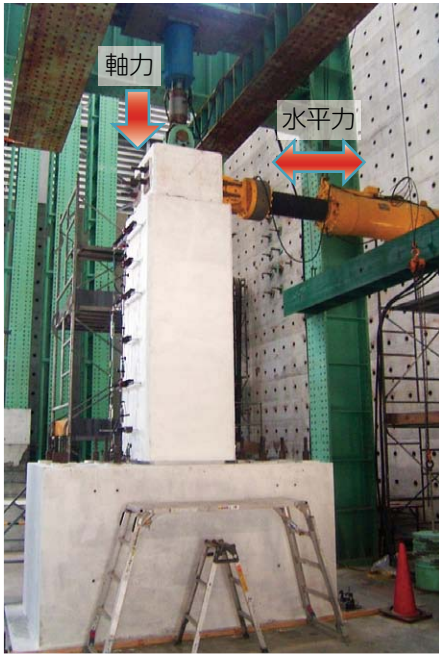
図4 実大試験体の荷重実験
