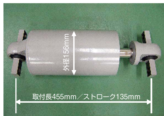
図2 地震対策左右動ダンパーの外観
