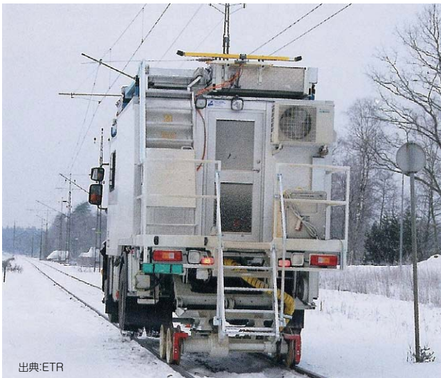
軌陸車上の測定システムOVHWizard
