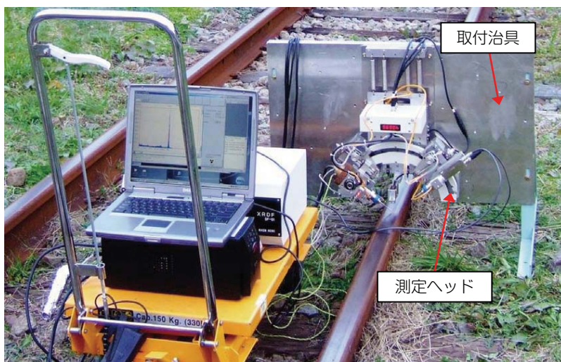
図 XRDFによるレール測定状況
