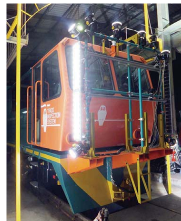
図2 軌道検測車に搭載したLED照明装置
