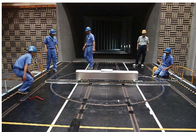
図6 縮尺1/10模型風洞試験
