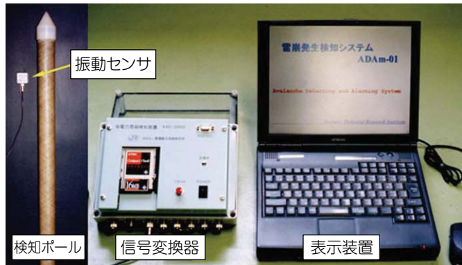
図8 振動センサを用いた雪崩検知装置とそのシステムの構成
