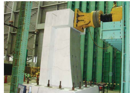
図9 実大試験体による荷重状況
