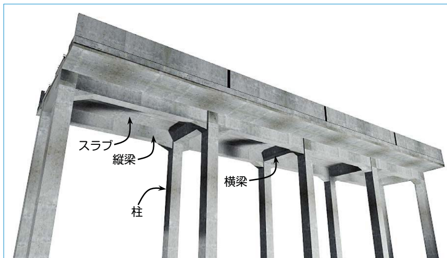
図1 ラーメン高架橋
