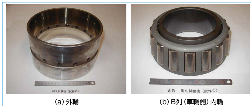
図3 合成系車軸軸受油の耐久試験後の試験軸受の状態
