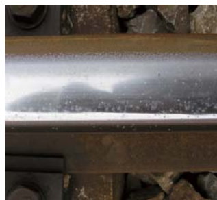
図2 噴射後のレール踏面
