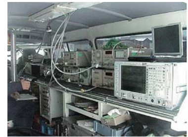
(b)測定車の中の測定機材
