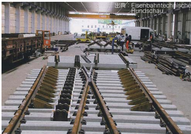
21の連結継手を含むEW 54-300のクロッシングと端のまくらぎ
