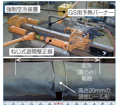
図7 使用装置と変形後の端部頭部形状
