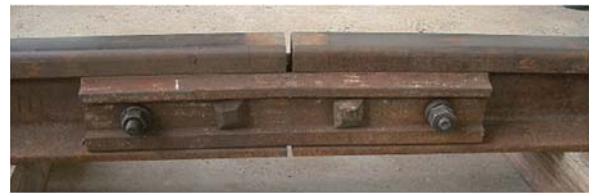
(b)450kNで整正後の継目の外観
