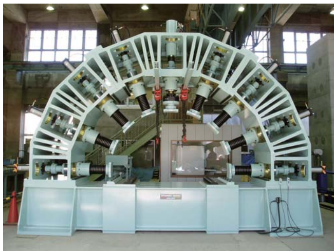
図4 大型トンネル模型載荷実験装置
