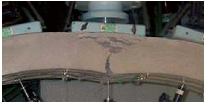
図8 トンネル模型の破壊と帯板の状況
