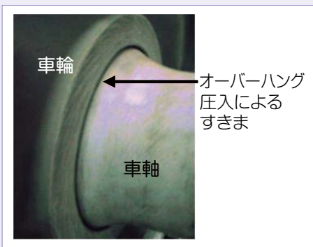
図3 車輪内ボス端のオーバーハング圧入
