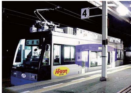
図2 LH02形架線・バッテリーハイブリッド(架線レス)LRV試験電車「Hi-tram(ハイ!トラム)」
