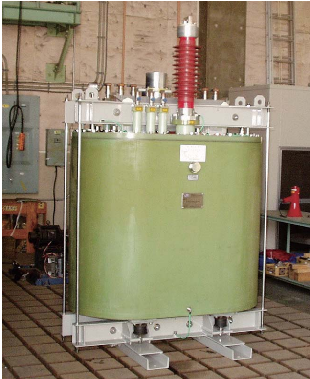
図7 試作した超電導主変圧器
