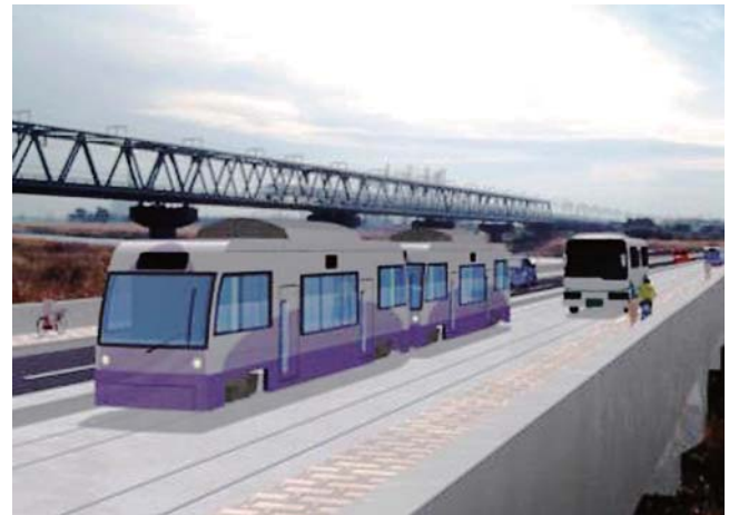
図7 架線レスLRTの走行イメージ
