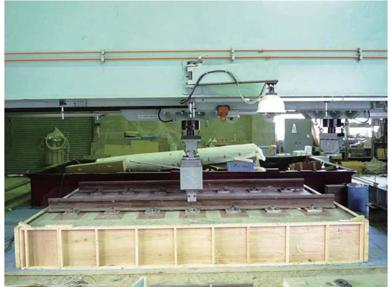
図 実物大軌道模型に対する繰返し载荷試験状況
