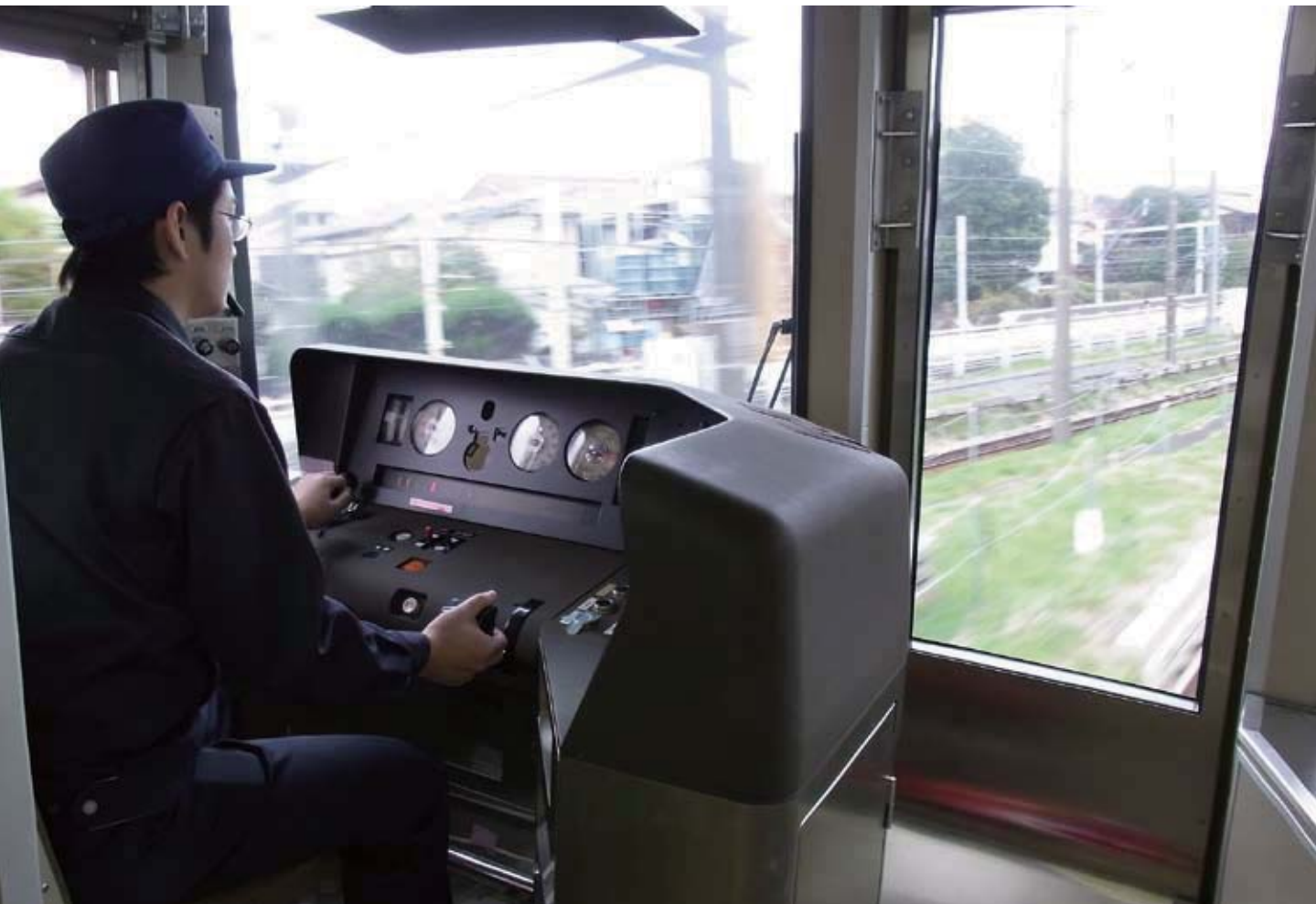
構内試験線において燃料電池車両 (R291 試験電車) の運転を行っている風景です。試験条件により加速ノッチやブレーキ開始の操作地点などが指定され、その操作には熟練が要求されます。
