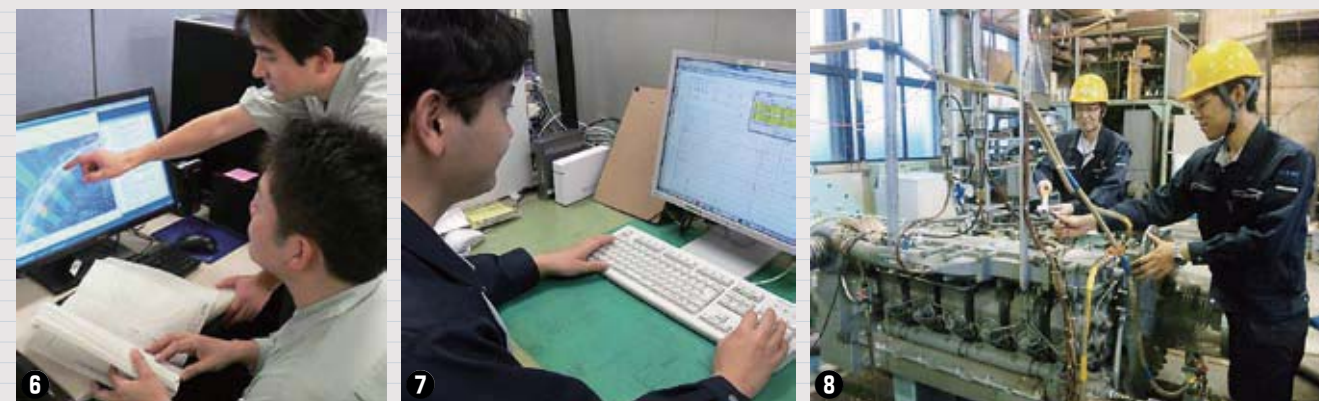
①燃料電池は手順書に沿って操作・起動します。②Hi-tram走行後、走行実績データを記録します。③走行試験では様々なデータを監視しながら走行指示を行います。④燃料電池ハイブリッドモニタ。⑤Hi-tramエネルギー表示モニタ。⑥誘導電動機の電磁界解析により損失発生部位の議論中。⑦エネルギーシミュレータを使って消費エネルギーを計算しています。⑧エンジンベンチテストでセンサーや配管を取り付けています。
