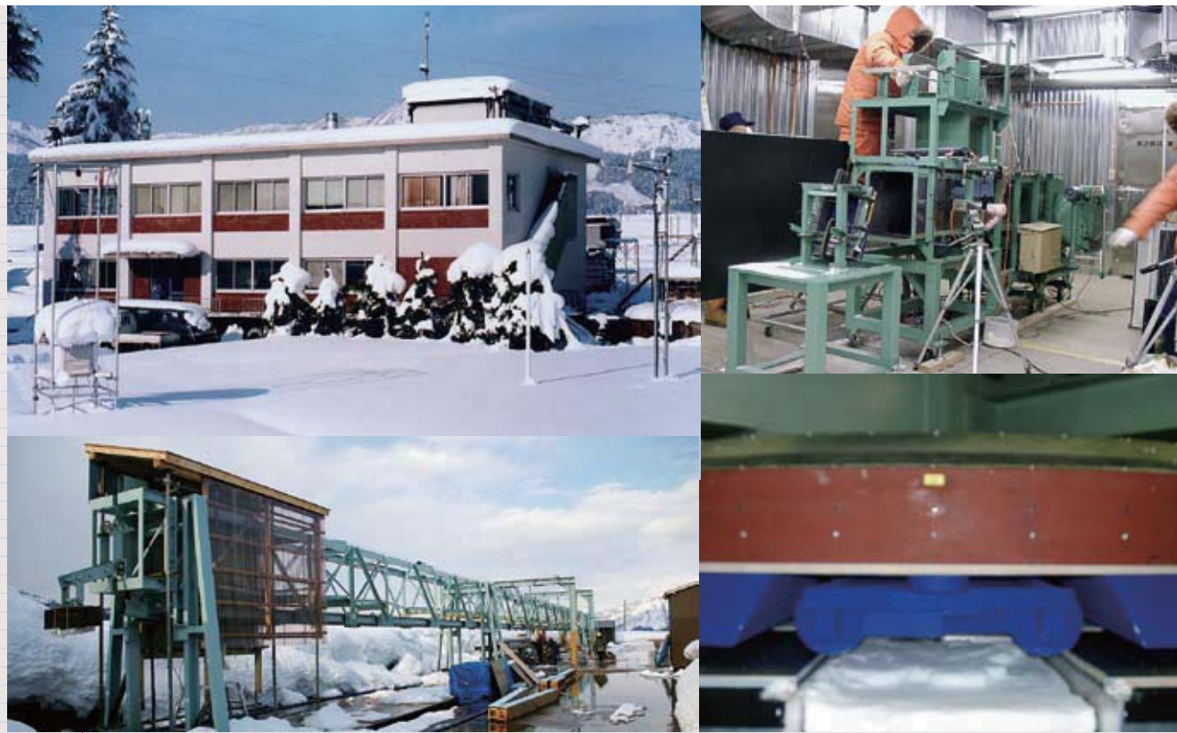
新潟県南魚沼市にある塩沢雪害防止実験所（左上）は、約16000m 2 の敷地を有し、屋外試験場のほか、温度-30～10℃の低温環境を再現する低温実験室（右上）、速度144km/hで模型を走行させることができる排雪力測定試験装置（左下）、直径5mの円盤を速度200km/hで回転させることができる高速回転円盤試験装置（右下）などの実験設備があり、雪害防止に関する種々の試験・研究を行っています。
