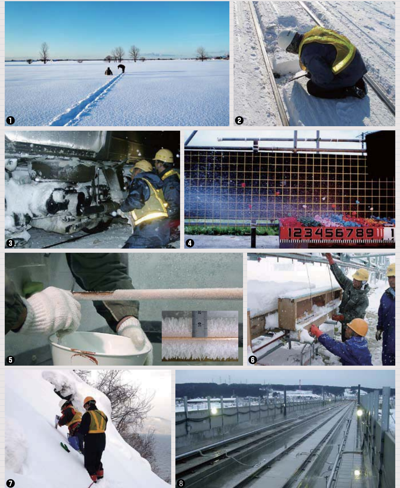
①広域積雪分布調査。②軌道内の圧雪調査。③車両床下の着氷雪調査。④走行車両からの落水雪によるバラスト飛散の再現試験。⑤架線着霜の再現試験。⑥スノーブラウ模型試験。⑦雪崩斜面積雪調査。⑧寒冷地における散水消雪試験（鉄道・運輸機構受託）。
