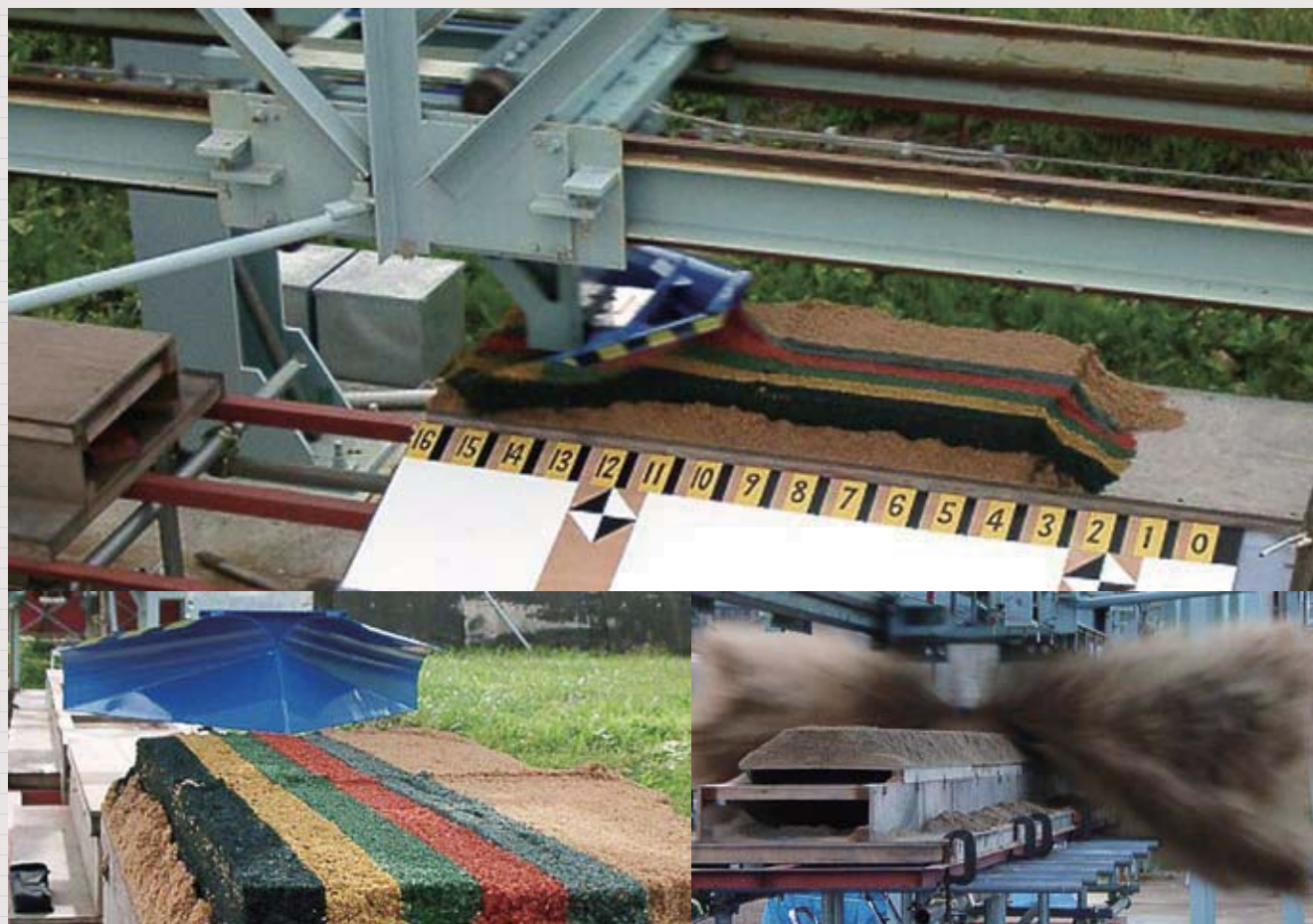
スノーブラウによる軌道上の飛雪方向は、スノーブラウの形状を決めるための重要な要素の一つです。雪の無い季節には、雪の代わりに着色して水を含ませたおが屑を用いて、飛雪分布などの評価試験を行っています。
