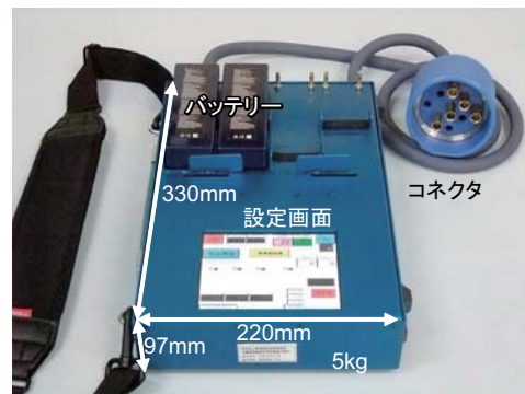
図1 断線箇所検知装置
