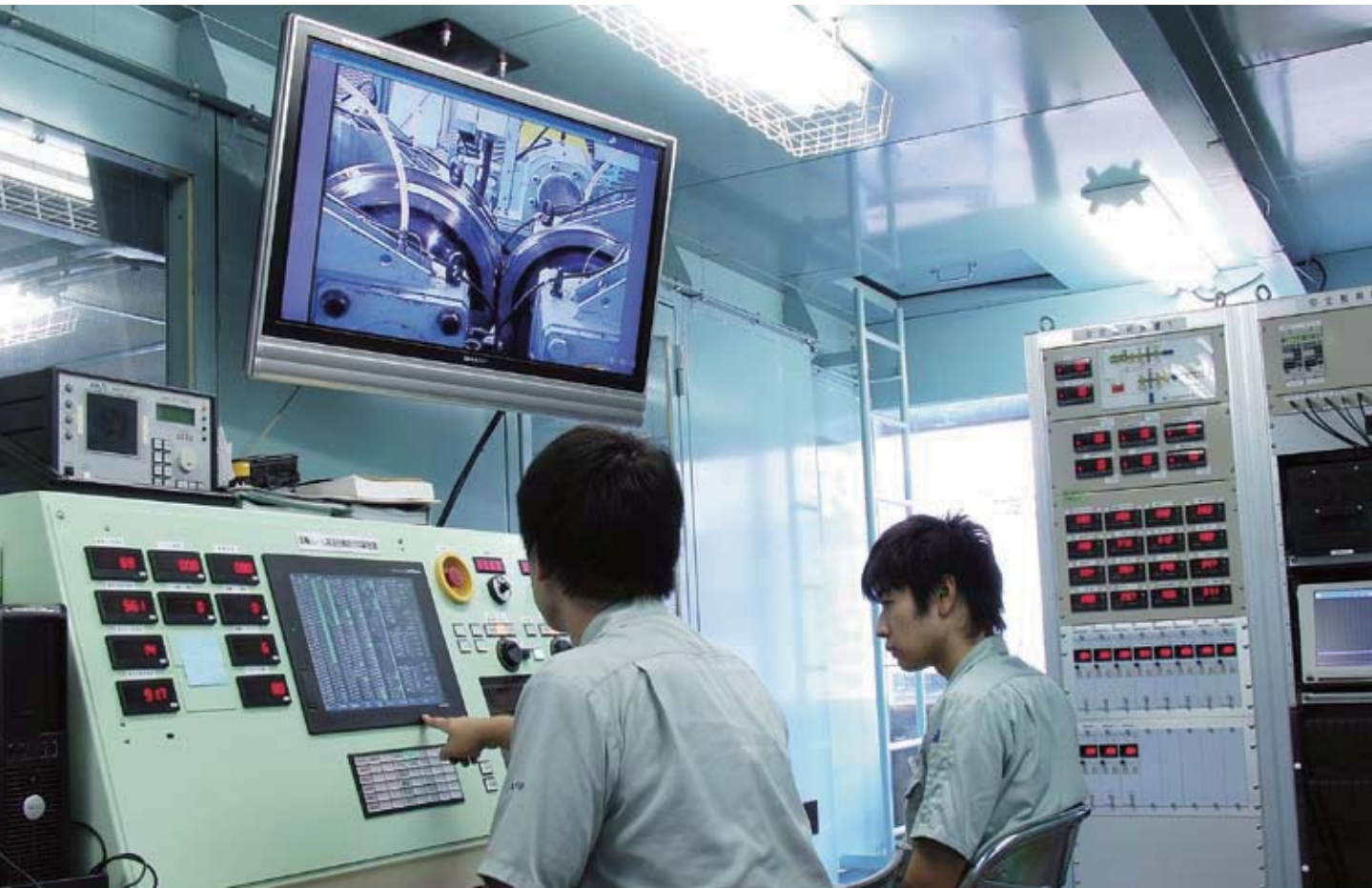
車輪・レール高速接触疲労試験装置の制御室の様子です。試験装置の制御、計測や安全監視を行っています。車輪・レール接触部の状態をモニタによって観察することができます。
