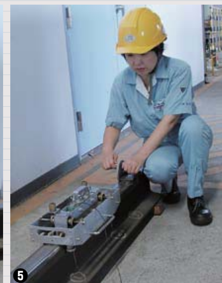
①インパルスハンマによるレール振動の調査。②車輪・レールの転がり接触シミュレーション。③バラスト軌道の粒状体シミュレーション。④レールゲージコーナ部の摩擦係数測定。⑤レール頭頂部の摩擦係数測定。⑥レールの超音波探傷。⑦レールの断面形状測定。
