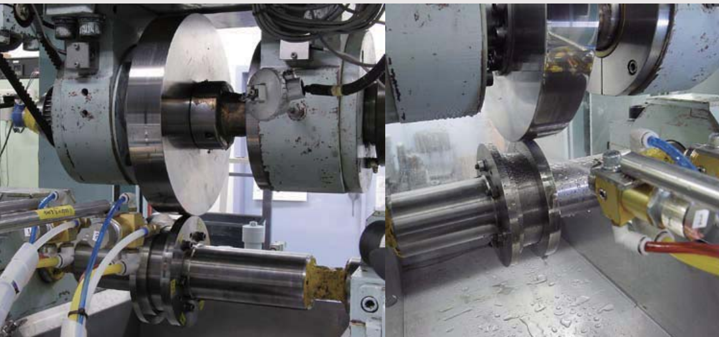
車輪・レール高速接触疲労試験装置は主に疲労現象を対象としていますが、この2円筒転がり接触試験機は、車輪・レール間の粘着力特性の解明を主な目的としています。右の写真は、ノズルから水を噴射し、水潤滑時の粘着力特性を調べています。
