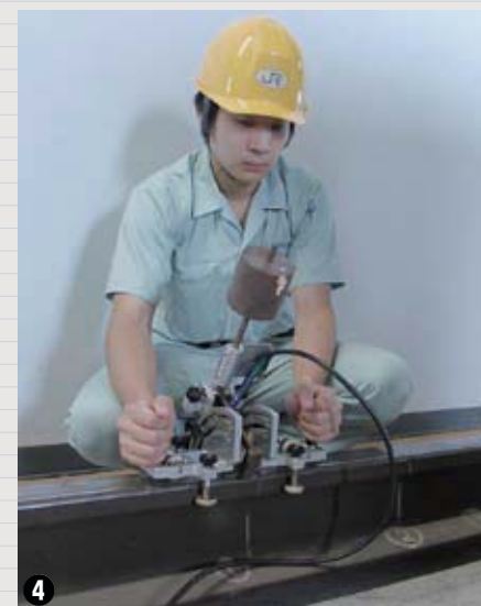
①インパルスハンマによるレール振動の調査。②車輪・レールの転がり接触シミュレーション。③バラスト軌道の粒状体シミュレーション。④レールゲージコーナ部の摩擦係数測定。⑤レール頭頂部の摩擦係数測定。⑥レールの超音波探傷。⑦レールの断面形状測定。
