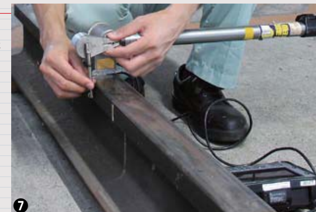
①インパルスハンマによるレール振動の調査。②車輪・レールの転がり接触シミュレーション。③バラスト軌道の粒状体シミュレーション。④レールゲージコーナ部の摩擦係数測定。⑤レール頭頂部の摩擦係数測定。⑥レールの超音波探傷。⑦レールの断面形状測定。
