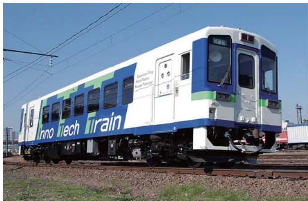
図8 JR北海道 モータ・アシスト式ハイブリッド車両 (写真提供：JR北海道)
