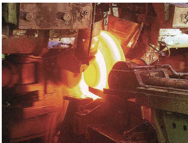
図9 車輪製造時の熱間圧延の例 1)
