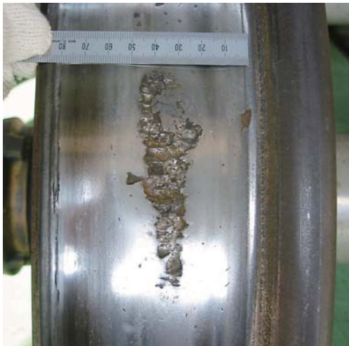
図4 車輪踏面のフラットによる表面はく離の例
