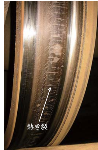
図6 車輪踏面熱き裂の例
