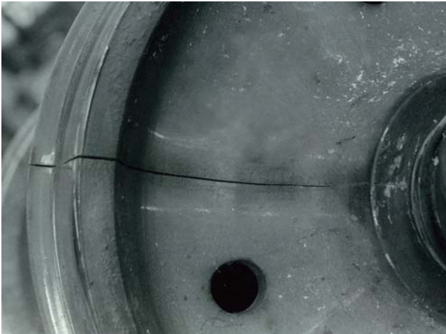
図12 車輪が割損した例(過去の事例)
