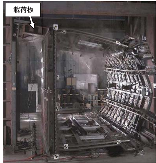
図5 衝撃後80ms時の変形状況(試験結果)
