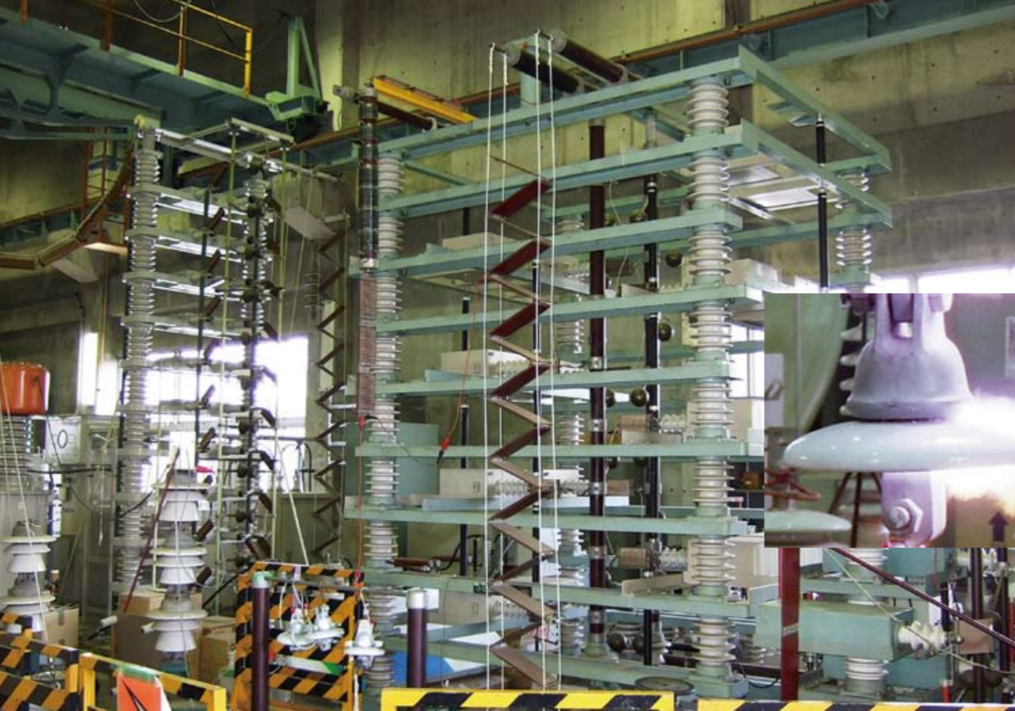
雷などによる衝撃電圧・電流を模擬的に発生させる装置です。各種絶縁材に要求される絶縁性能の確認や、絶縁破壊など異常時の現象解明を行っています。写真右は衝撃電圧によってがいしが一時的に絶縁破壊する様子を写したものです。
