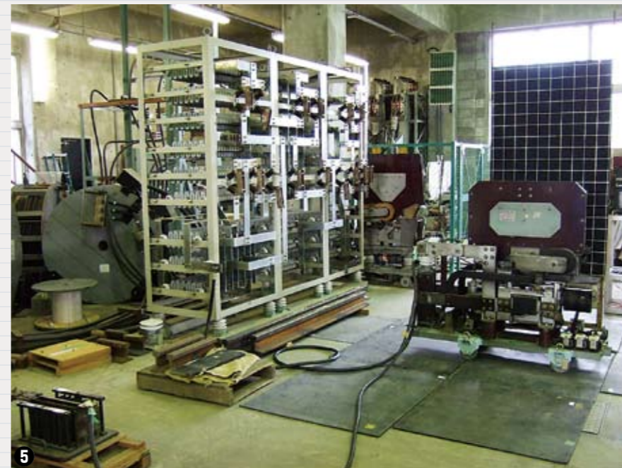
異常時の大電流を遮断する直流遮断器の試験の様子。①周辺の電源に影響を与えないように用いる電動発電機。②交流電力を直流に変換する整流器。③④発電機を回すモータの電気をカットした後、試験回路に大電流を流す様子。連絡を取り合っている緊迫の瞬間。⑤直流遮断器(右側)と試験回路。⑥電流遮断の瞬間。火花(アーク)を外に押し広げることによって電流を遮断する遮断機。
