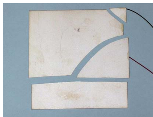
図2 割れた圧電セラミックス
