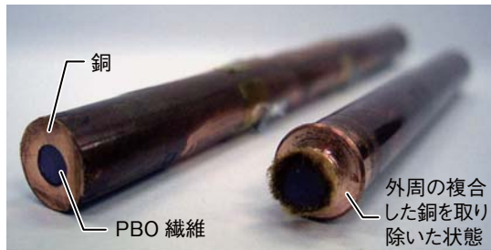
図3 機械的に銅とPBO繊維を複合した線材
