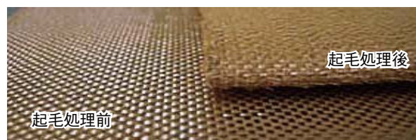
図8 起毛処理によるPBO繊維クロスの変化
