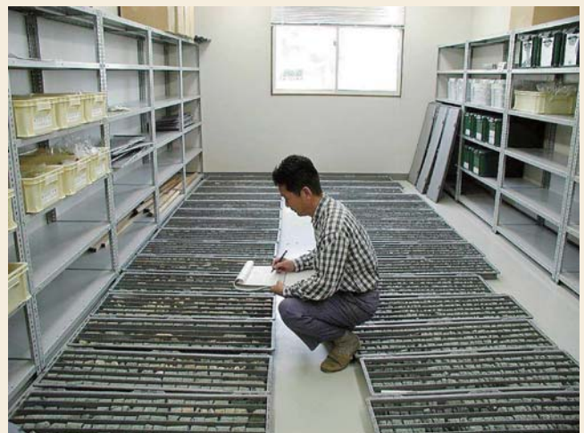
図2 八甲田試験室におけるボーリングコア分析
