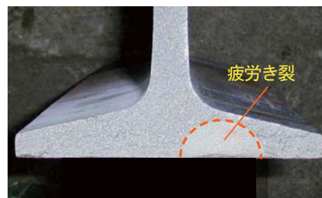
図4 疲労試験による底部破面の例
