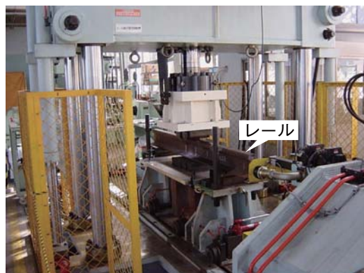
図1 レール曲げ疲労試験機
