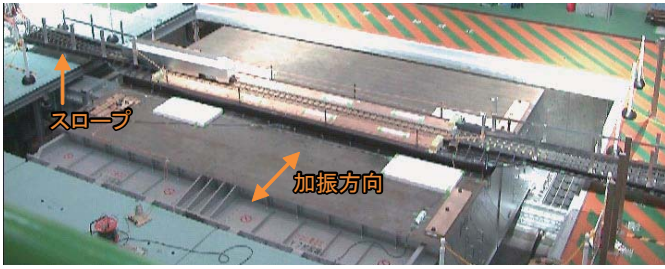
図7 振動台上に設置した軌道上を走行する模型車両
