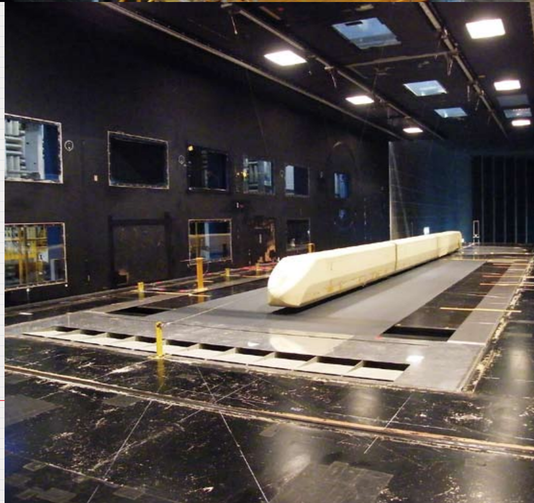
開放型測定部 試験風景 ・パンタグラフの空力音、揚力の測定 ・縮尺模型を用いた空力音、流れ場の測定 ・自動車、航空機、高層ビルに関する空力音の測定
