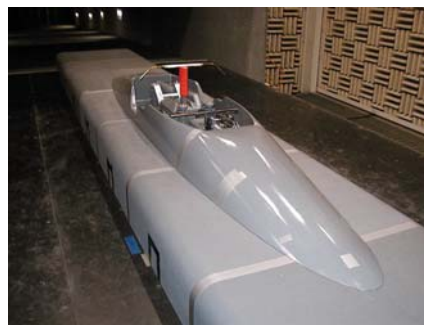
図6 1/3スケール集電装置模型による風洞試験
