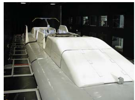
図7 実物パンタグラフと実物碍子オオイの組合せ試験
