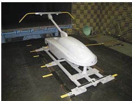
図5 実物パンタグラフ単体の風洞試験
