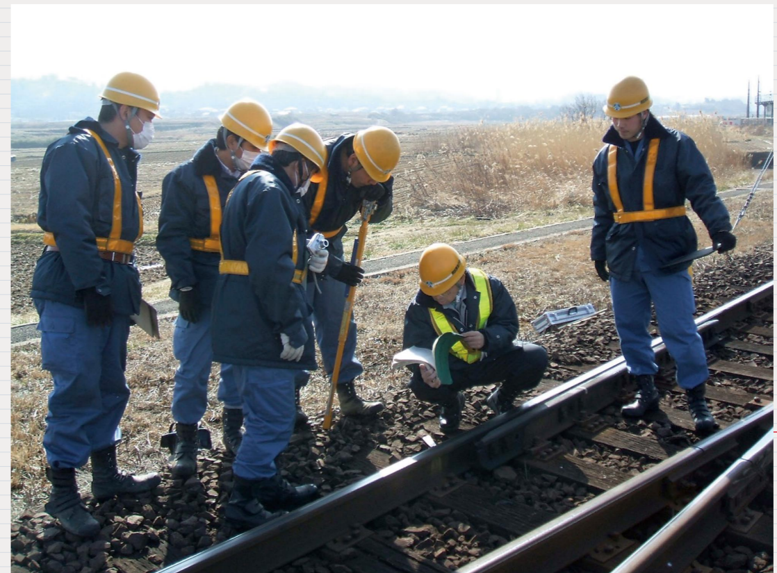
【現地調査】 ガードレールと車輪フランジ間の擦り傷の対策について、鉄道総研の研究者が現地にて指導しています。
