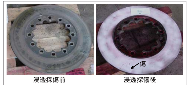
図4 ブレーキディスクの浸透探傷の試験前後の外観
