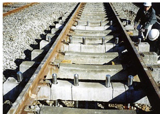
図2 現場での密度測定器の設置の様子
