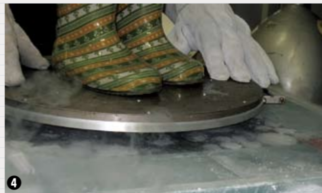
①超電導ケーブル試験用端末容器の組み立て作業。②超電導ケーブルの組み立て作業。③④所内で製作した超電導バルク材を用いた浮上デモ。⑤10T超電導マグネット（ボア径100mm）による実験風景。⑥大型5T超電導マグネット（ボア径400mm）による実験風景。
