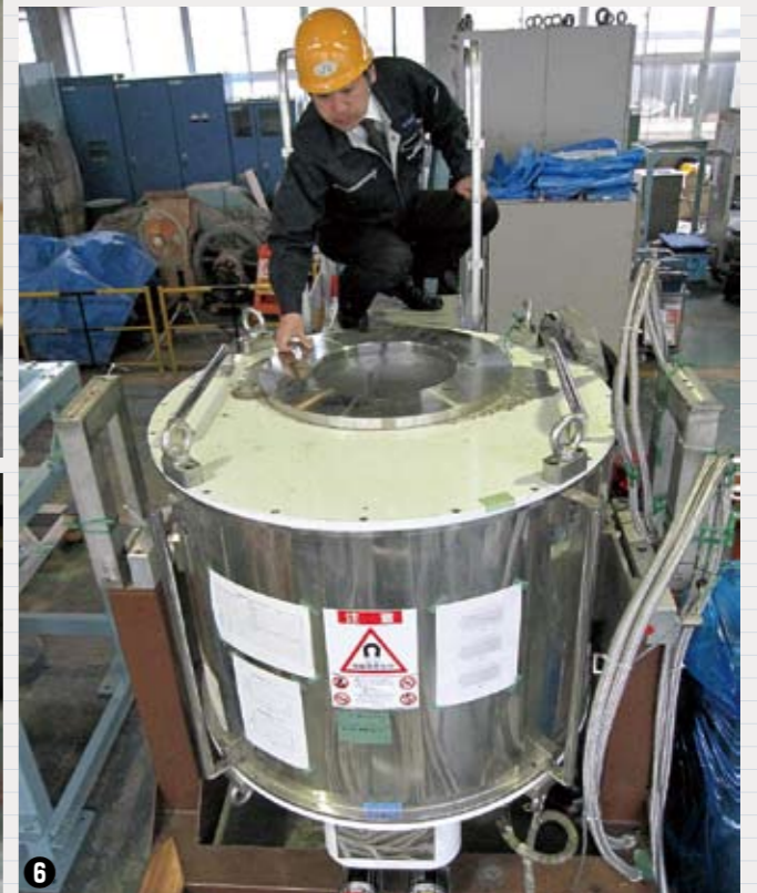
①超電導ケーブル試験用端末容器の組み立て作業。②超電導ケーブルの組み立て作業。③④所内で製作した超電導バルク材を用いた浮上デモ。⑤10T超電導マグネット（ボア径100mm）による実験風景。⑥大型5T超電導マグネット（ボア径400mm）による実験風景。
