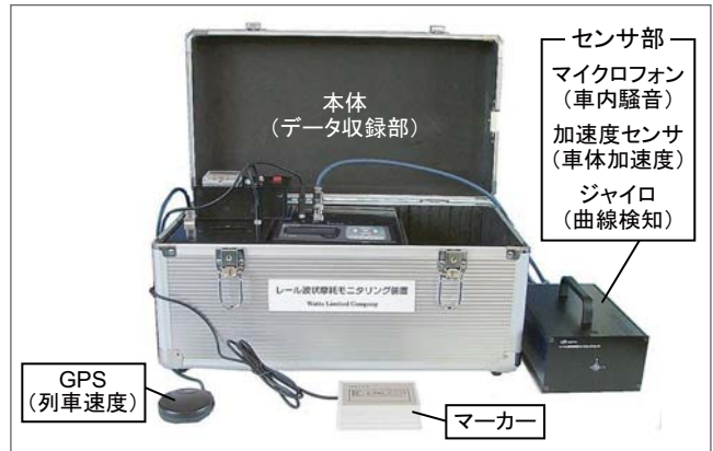
図7 可搬型波状摩耗モニタリング装置の外観
