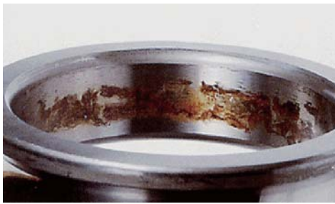
図7 軸受に発生したフレッチングコロージョンの例
