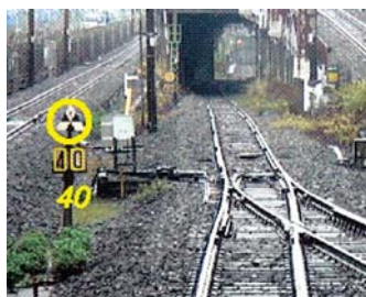
図1 車上型徐行予告信号機認識システム
