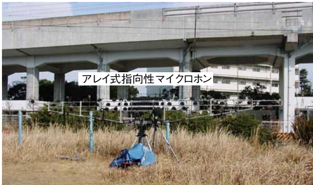
図2 アレイ式指向性マイクロホンによる騒音測定状況
