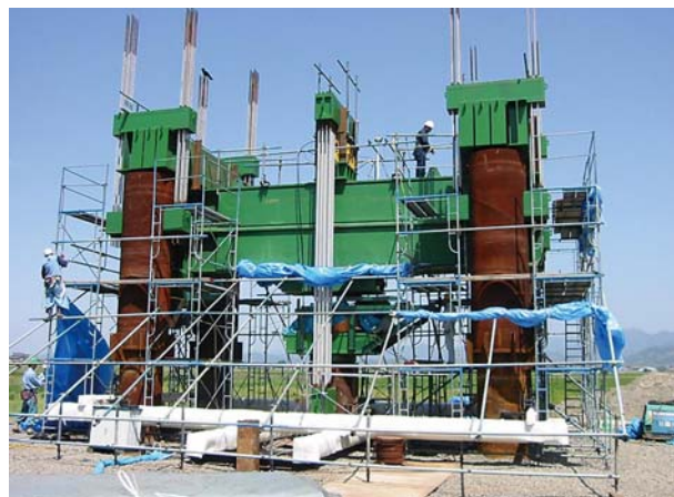
図5 回転杭の鉛直交番載荷試験の状況
