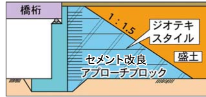
図13 セメント改良補強土橋台
