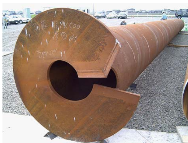
図6 試験杭(回転杭)
