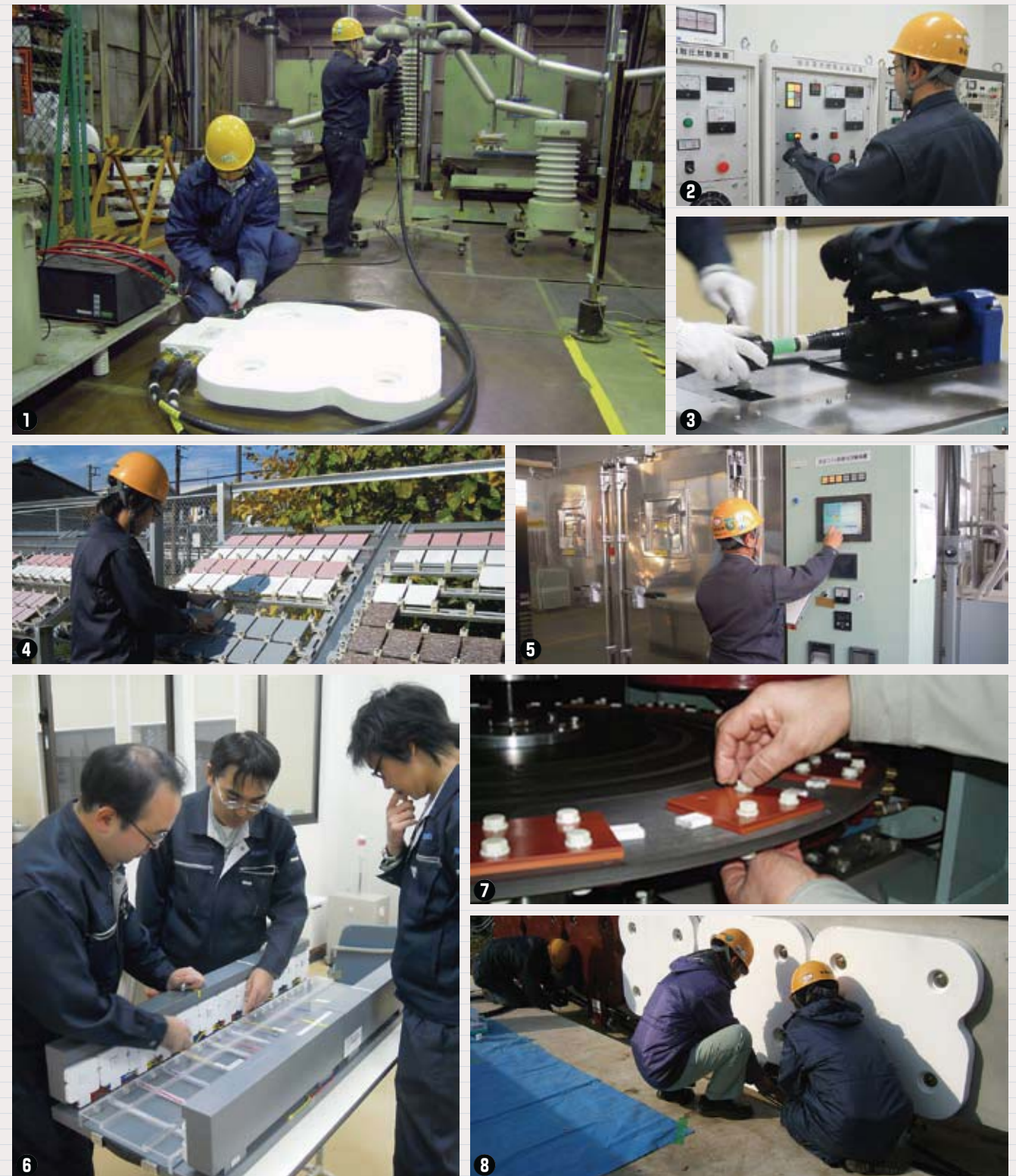
①欠陥模擬コイルを対象とした部分放電測定による絶縁劣化診断中。②課電試験装置を操作し、供試体に高電圧を印加します。③ケーブル接続部の加振試験を準備しています。④屋外暴露試験片の耐候性を調査しています。⑤超促進耐候性試験装置により、実機コイルの耐候性を評価します。⑥ガイドウェイ模型を使い、PLGコイルの配線施工性を検討中。⑦回転円板に線材サンプルを設置し、励磁の有無による渦電流損失を定量評価します。⑧実物大ガイドウェイを用い、PLG方式電磁路の施工性を検証中。
