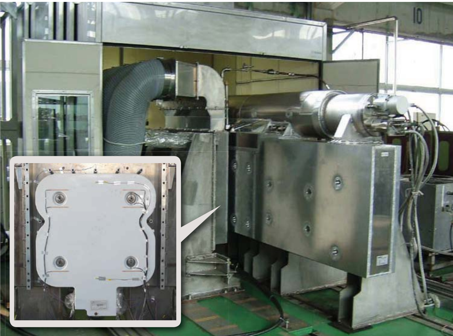
強力な超電導磁石に対向設置した地上コイルに交流電流を通電することにより、車両通過時を模擬した電磁加振試験が可能となります。定置にて、実走行と同様な動的耐久性が検証できます。
