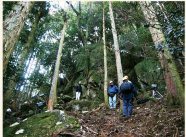
図2 鉄道沿線岩盤斜面における振動計測実験の様子
