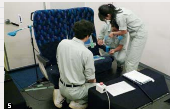
①車内快適性シミュレータで目的に応じた車内環境を模擬し、そこに必要な計測装置を設置することで、さまざまな利用者特性を測定しています。②③④鉄道利用者に実場面を想定した体感評価を行っていただいているところです(②は多目的スペースにおけるベビーカー使用体験、③は通勤ラッシュを想定した混雑体験で、ピンクボールは頭部の揺れを記録するためのターゲットマーカー、④はつり革の握まりやすさの調査です)。⑤車内振動騒音評価シミュレータで実際の走行振動や車内騒音の再現と、加工した振動・騒音を起こす準備をしています。⑥ヘッドマウントディスプレイを装着して風景も体感できます。⑦振動・騒音の体感実験を実施し、データを取得しています。
