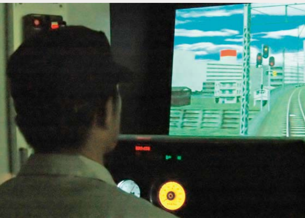
列車運転シミュレータで運転行動の特徴を測定しているところです。実際の運転環境を模擬できるシミュレータで、安全運転のための基礎データの収集が行われています。
